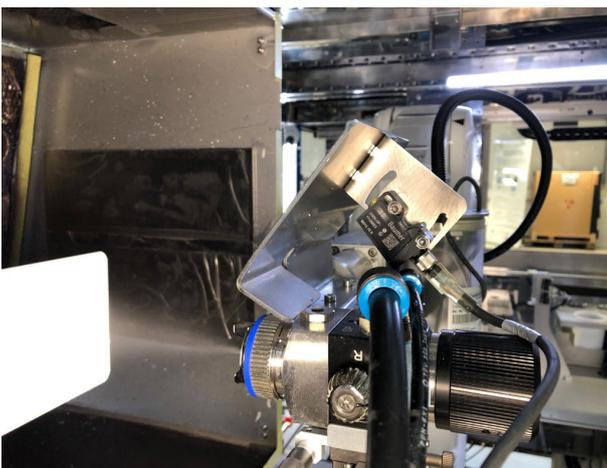
6 Einstellung des Strahls für die Spraybeschichtung
