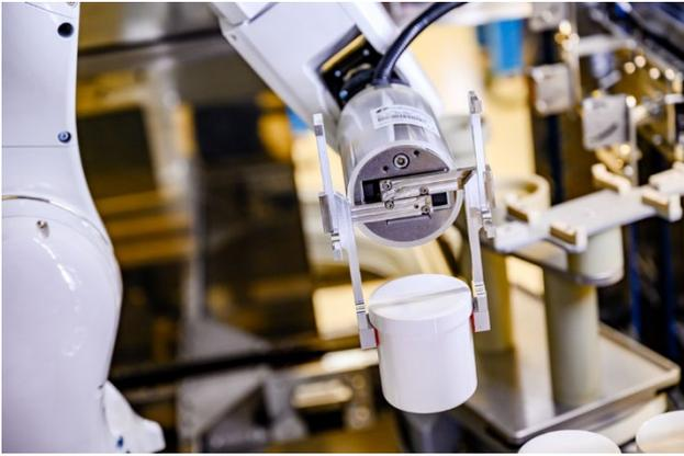
5 Roboter, der nach dem Mixen die Probe zur Weiterfahrt auf dem Shuttle ablegt
